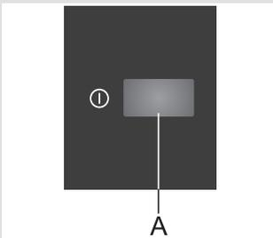
Aparatul poate fi pornit și oprit cu ajutorul butonului on/off **A**.
